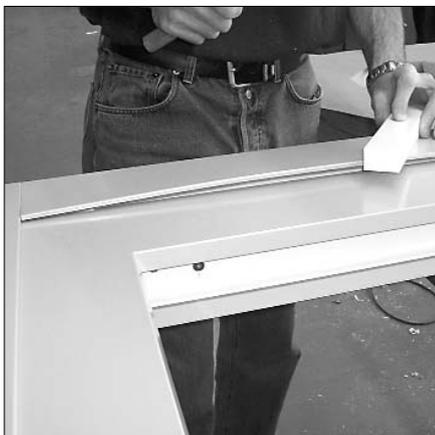
Zur besseren Montage der Alublende können Hilfsmittel verwendet werden, wie z.B. Gummihammer, PVC-Platte (siehe Abbildung).
